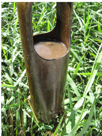
Figure 22 : Photo d'un carottage réalisé sur un lit garni de compost trop fin et donc imperméable (crédit photo : Irstea)
