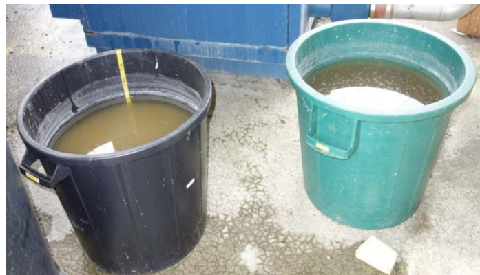
Figure 37 : Photographie des silos pilotes de boues chaulées mis en place à la STEU de Meyronne-Creysse.
