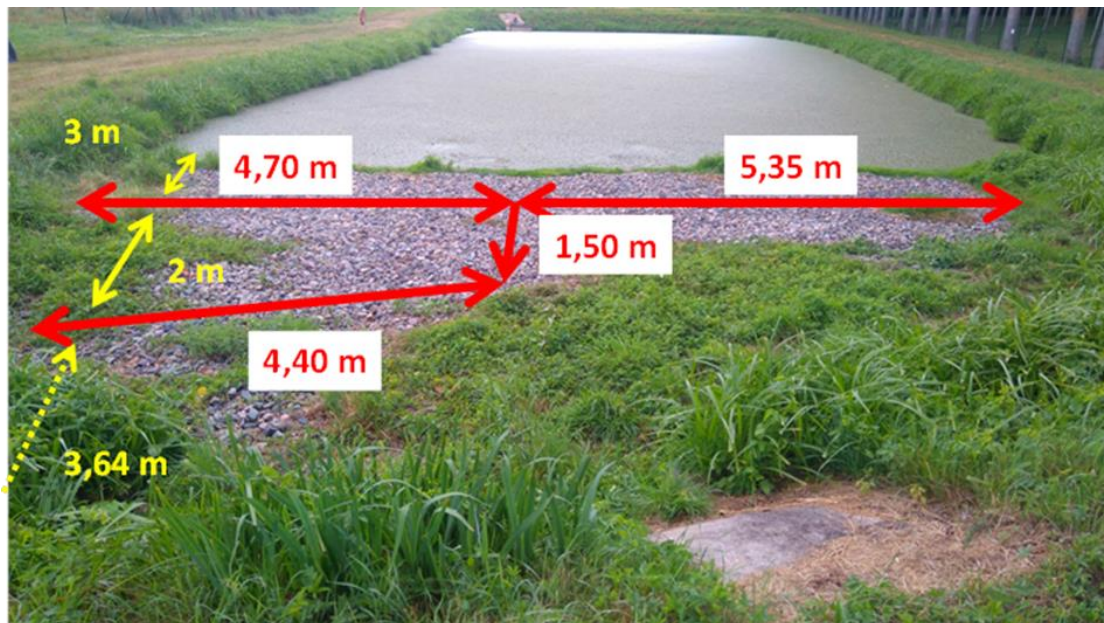
Figure 15: Dimensions réelles du drain dans le rock filter
