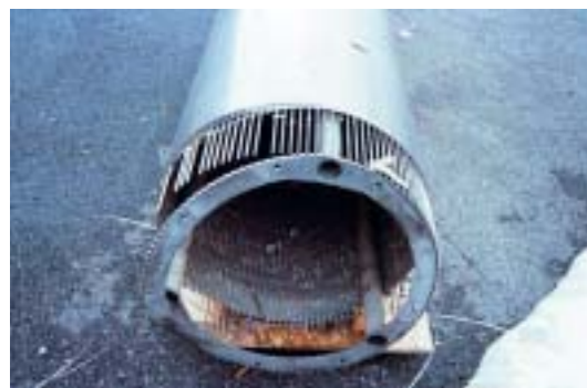
Photos 8 et 9 – Détérioration d'un tamis par les sables et graviers.
