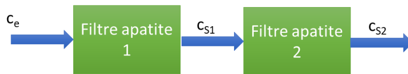
Figure 8. Configuration à deux filtres à apatite en série
