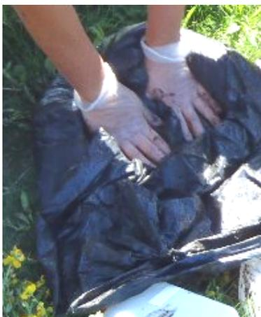
**Figure 4 – Homogénéisation de l'échantillon moyen à travers un sac plastique**
