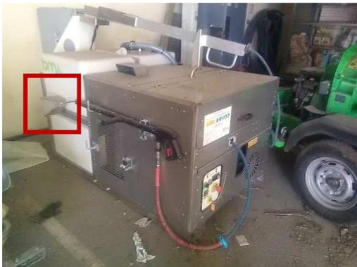
Figure 24 : Désherbeuse thermique (ARPE PACA)
