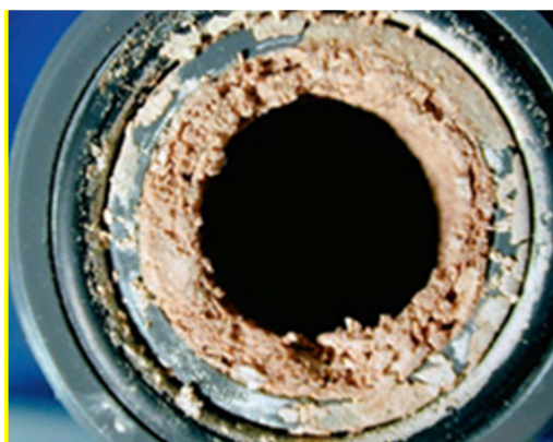
Figure 6 : Exemple de colmatage des canalisations d'évacuation des urines par les précipités (Eawag, 2007)
