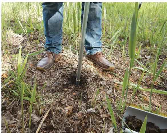
Figure 6. Prélèvement d'un échantillon de sol.
