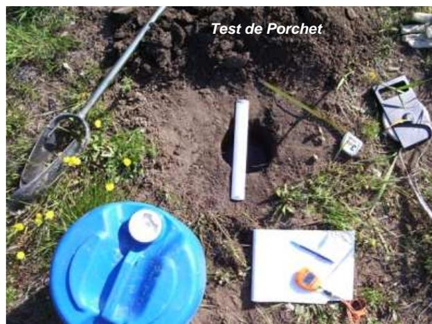
L'infiltration de l'eau dans le sol est suivie en fonction du temps, après saturation, et
