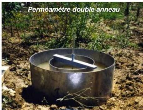
L'appareil utilisé est appelé « infiltromètre à double anneau » ou « perméamètre double anneau ». Il est utilisé pour mesurer le coefficient de perméabilité à saturation du sol (détermination ponctuelle, *in situ*, de la perméabilité verticale du sol). Cette méthode est effectuée sur le sol en place sans réalisation d'une cavité.
